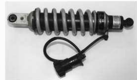
Dieses Modell wird bei sehr vielen BMW's als hinteres Federbein verwendet
